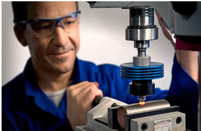
На рисунке показан первый этап производства – получение отверстия с помощью термосверла Thermadrill.
